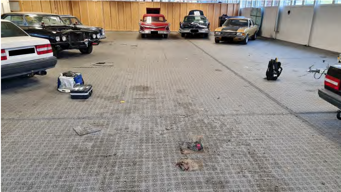
Figur 5.2 Läge för provpunkt 23SM08. Grundvattenrör har installerats med röröverkant i nivå med golv.
