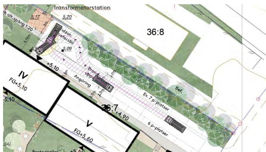
Figur 16. Körspår för skåpbil/mindre lastbil mot planerad transformatorstation
