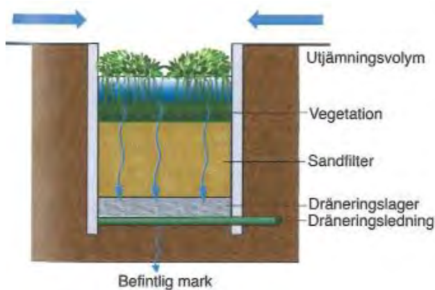
Figur 18. Principiell utformning av en regnbädd för fördröjning och rening av dagvatten (Svenskt Vatten, 2016).
